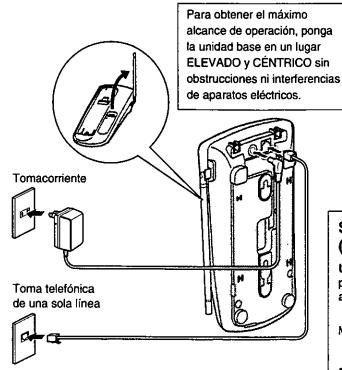
El adaptador de CA debe permanecer conectado en todo momento. Conecte como se muestra.
