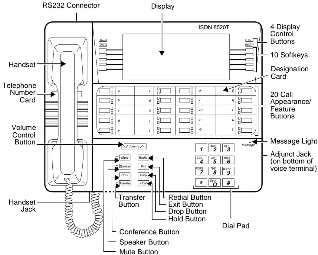
Figure 16-6. The ISDN 8520T Voice/Data Terminal
