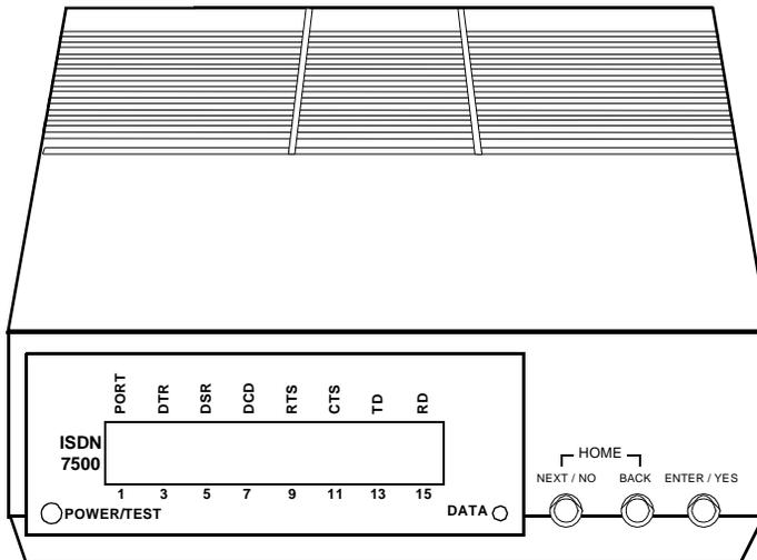
**Figure 20-9. The 7500B Data Module**
